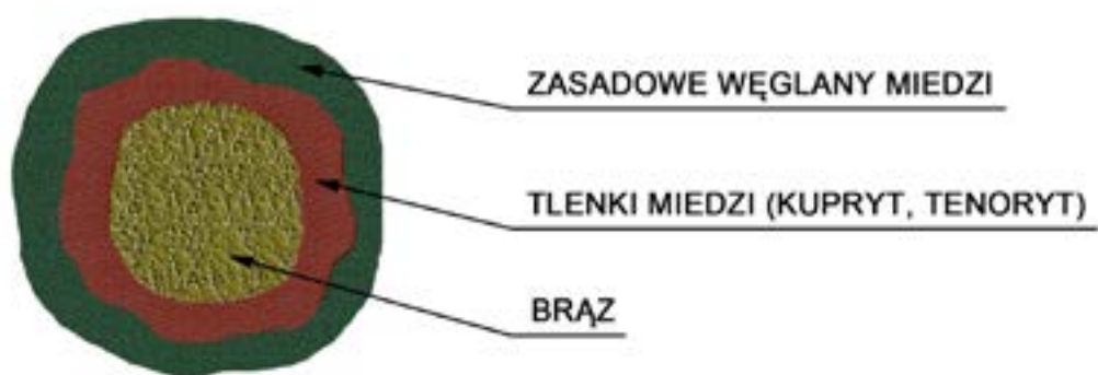
Ryc. 3. Uproszczony schemat powstawania nawarstwień korozyjnych w obecności jonów chloru. Rys. Sz. Bednarz Fig. 3. A simplified diagram of the formation of corrosion layers in the presence of chlorine ions. Drawn by Sz. Bednarz
