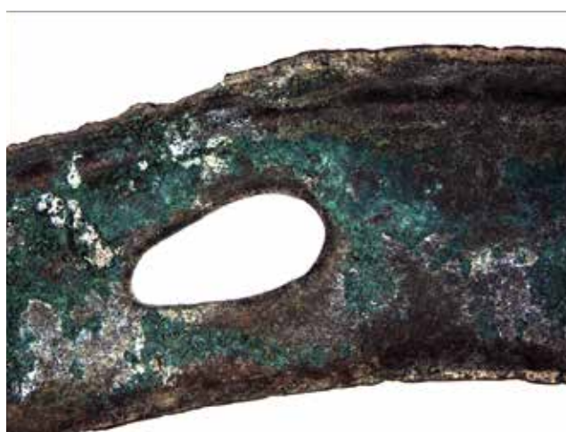
Ryc. 31. Nowe Kramsko, gm. Babimost. Makrostruktury sierpa NK 29. Na zdjęciu widoczny jest niedolew w górnej części ostrza (pow. \times 3,5 )
