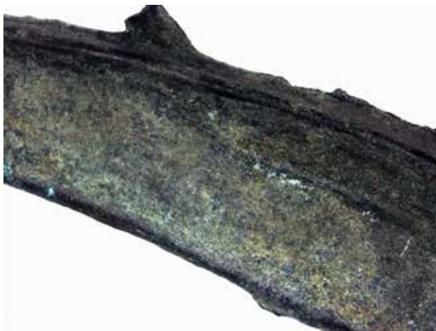
Ryc. 33. Nowe Kramsko, gm. Babimost. Makrostruktury sierpa NK 69. Na zdjęciu widoczna jest zalewka na zewnętrznej krawędzi ostrza, która może być śladem celowo wykonanego odpowietrzenia formy (pow. \times 3,5 )
