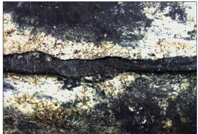
Ryc. 12. Nowe Kramsko, gm. Babimost. Makrostruktury siekiery NK 5. Na zdjęciu widoczna jest częściowo zeszlifowana zalewka na płaszczyźnie podziału (pow. \times 3,5 )
