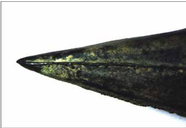
Ryc. 11. Nowe Kramsko, gm. Babimost. Makrostruktury siekiery NK 1. Na zdjęciu widoczna jest zalewka na płaszczyźnie podziału formy (pow. \times 3,5 )
