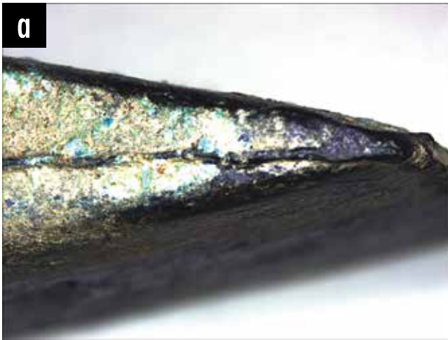
Ryc. 13. Nowe Kramsko, gm. Babimost. Makrostruktury siekiery NK 3. Na zdjęciach widoczne są (a) zalewki na płaszczyźnie podziału formy i (b) niedolewy kołnierza tulei i uszka (pow. \times 3,5 )
