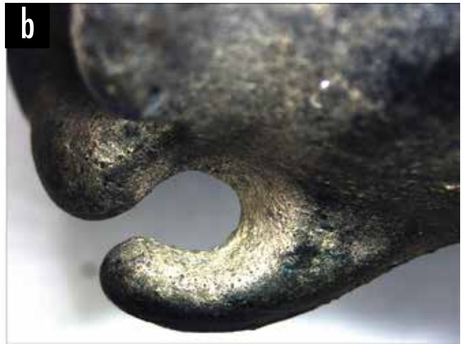
Ryc. 13. Nowe Kramsko, gm. Babimost. Makrostruktury siekiery NK 3. Na zdjęciach widoczne są (a) zalewki na płaszczyźnie podziału formy i (b) niedolewy kołnierza tulei i uszka (pow. \times 3,5 )
