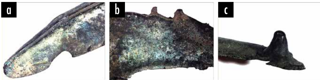
Ryc. 30. Nowe Kramsko, gm. Babimost. Makrostruktury sierpów (a) NK 21, (b) NK 33 i (c) NK 49. Na zdjęciu widoczne są niedolewy (a) na końcu ostrza, (b) na zewnętrznej krawędzi ostrza oraz (c) przy guzku (pow. \times 3,5 )
