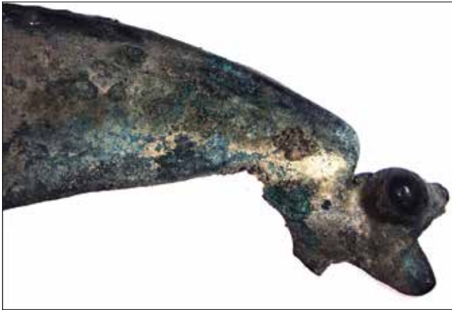
Ryc. 26. Nowe Kramsko, gm. Babimost. Makrostruktury sierpa NK 32. Na zdjęciu widoczne jest niedolane ostrze w okolicy guzka i układu wlewowego (pow. \times 3,5 )
