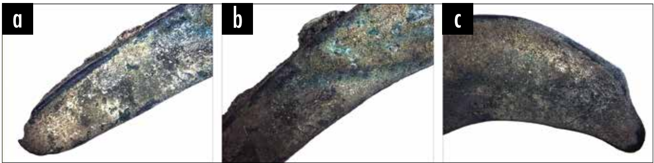
Ryc. 28. Nowe Kramsko, gm. Babimost. Makrostruktury sierpa NK 53. Na zdjęciu widoczne są (a-b) zalewki na płaszczyźnie podziału formy oraz (c) brak guzka i układu wlewowego (pow. \times 3,5 )
