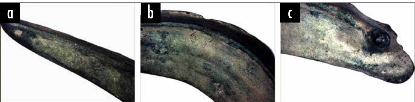
Ryc. 29. Nowe Kramsko, gm. Babimost. Makrostruktury sierpa NK 71. Na zdjęciu widoczne są (a-b) zalewki poza krawędzią zewnętrzną oraz (c) pozostałości układu wlewowego o małym przekroju (pow. \times 3,5 )
