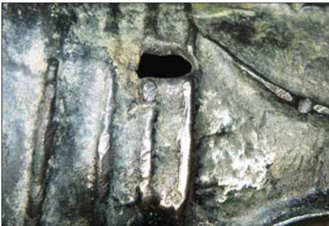
Ryc. 14. Nowe Kramsko, gm. Babimost. Makrostruktury siekiery NK 11. Na zdjęciu widoczny jest niedolew na kołnierzu tulei (pow. \times 3,5 )
