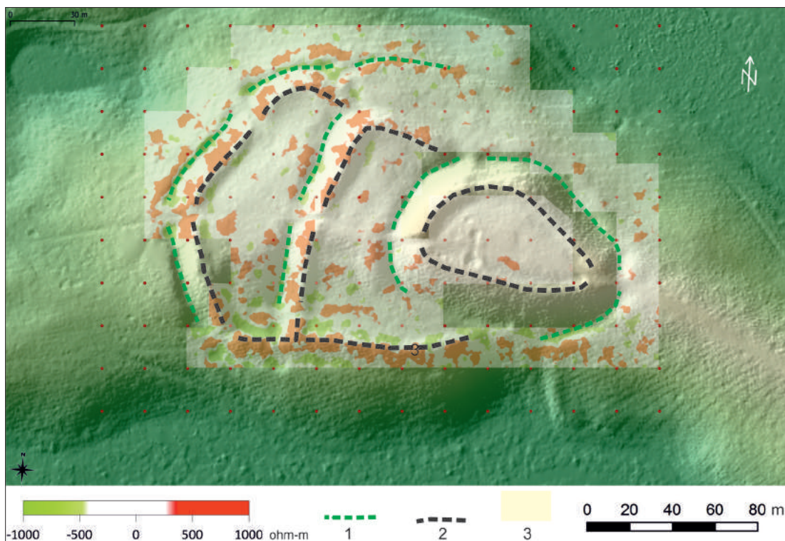
Ryc. 21. Tarnawa Rzepińska, stan. 1, pow. słuwicki. Obszary o najwyższych i najniższych opornościach, wydzielone na mapie rozkładu oporności pozornej gruntu, przetworzonej przy użyciu algorytmu high pass filter . 1 – linia oznaczająca obniżenia (rowy); 2 – linie biegnące wzdłuż szczytów wałów; 3 – obszar objęty pomiarami, oprac. T. Herbich
