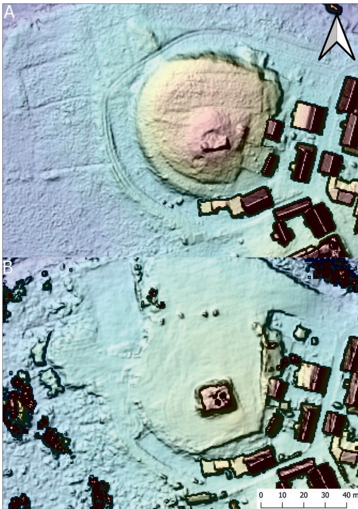
Ryc. 11. Gródek stożkowy w Lubrzy: w okresie poprzedzającym zniszczenie (A); w krótkim czasie po zniszczeniu (B). Porównanie analizy cieniowania DFM z danych z lotniczego skanowania laserowego (A) z analizą cieniowania z numerycznego modelu pokrycia terenu wygenerowanego ze zdjęć z drona z użyciem modelowania Structure from Motion. Oprac. G. Kiarszys (A) i K. Hanus (B)
